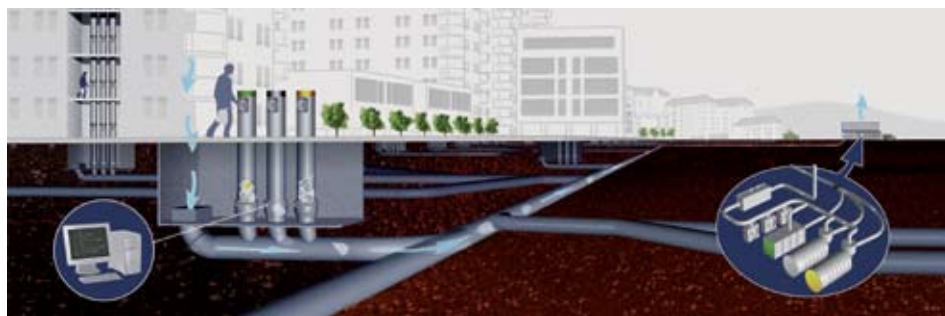
Figure 12 : Système de collecte pneumatique (source : Envac)
